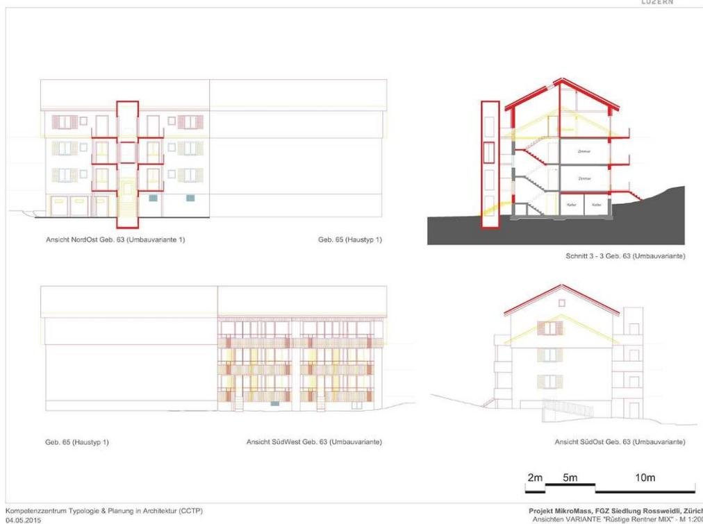
Abb. 93: Rüstige Rentner Mix: Ansichten / Schnitte Wohngebäude Im Rossweidli 63, 65 und 83 nach dem Umbau [Quelle: CCTP]
