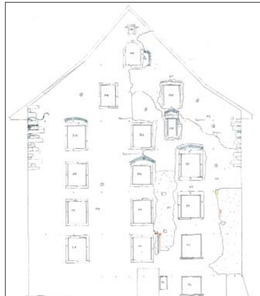
Abb. 8: Nordfassade. Zustand vor der Restaurierung. Plan: Kantonsarchäologie Aargau, Mauerwerksdatierung.
